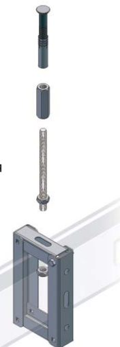
Монтаж к потолку
