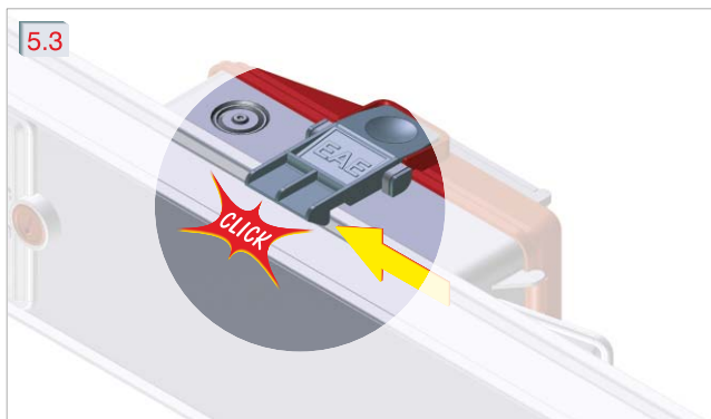
Убедитесь в том, что коробка прочно зафиксирована на корпусе шинопровода.
